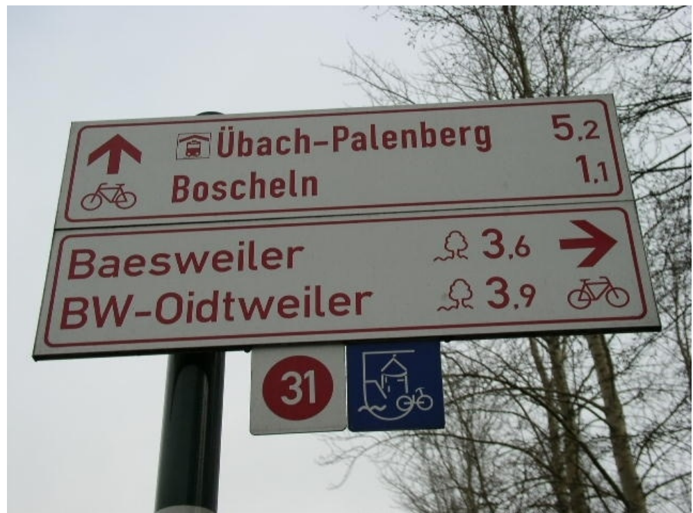
Abb. 3-9: Tabellenwegweiser mit Routeneinschüben
