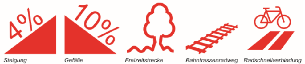
Abb. 3-4: Streckenpiktogramme (Platzierung rechtsbündig vor der Entfernungsangabe), i.d.R. ohne Rahmen
