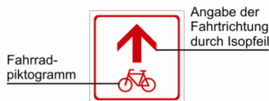
Abb. 3-6: Wegweiserinhalte Zwischenwegweiser, vgl. Kap. 3.1.1.3
