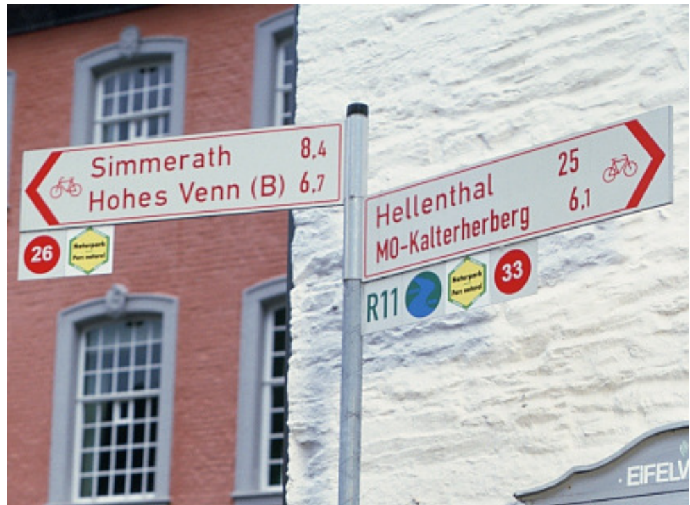
Abb. 3-1: Kombination von ziel- und routenorientierter Wegweisung
