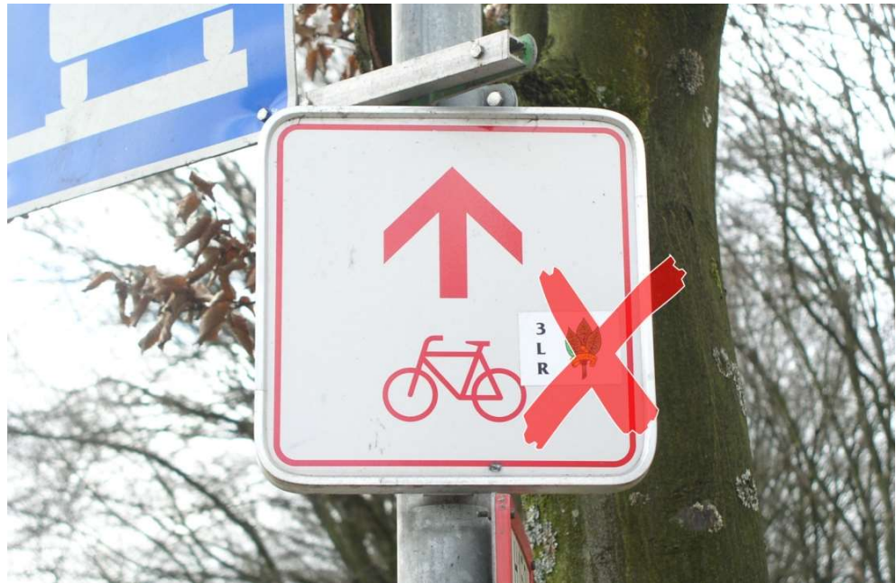
Abb. 3-22: Beispiel für unzulässige Integration von Routen auf Zwischenwegweisern (Mangel wurde inzwischen behoben). (Quelle IVV)
