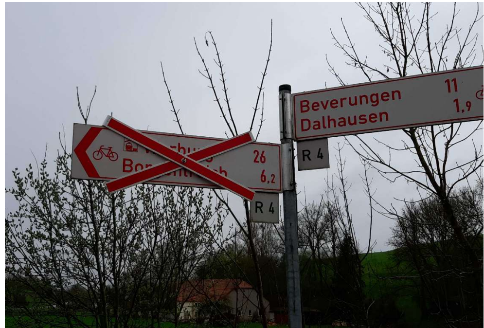
Abb. 8-7: Auskreuzvorrichtung zum Entwerten von Verkehrszeichen (Quelle: Landesbetrieb Straßenbau NRW)
