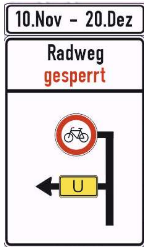
Abb. 8-8: Übersichtstafeln für Umleitungsbeschilderung nach RUB
