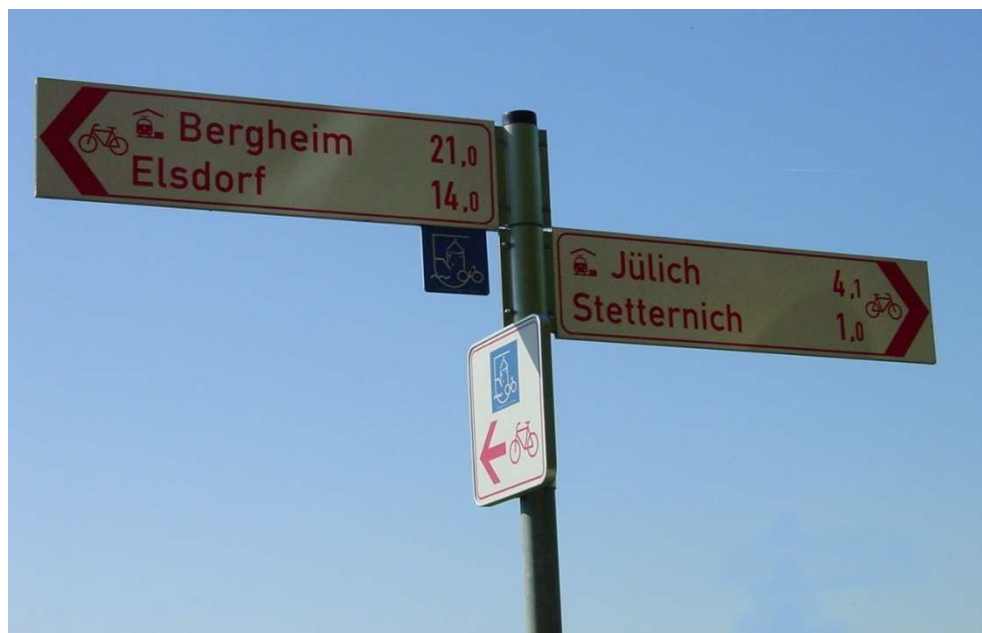
Abb. 3-25: Routenabzweiger zur Kennzeichnung von vorhandenen Routen ohne HBR-Beschilderung, die von der ausgewiesenen Route abzweigen (Quelle: SVK)
