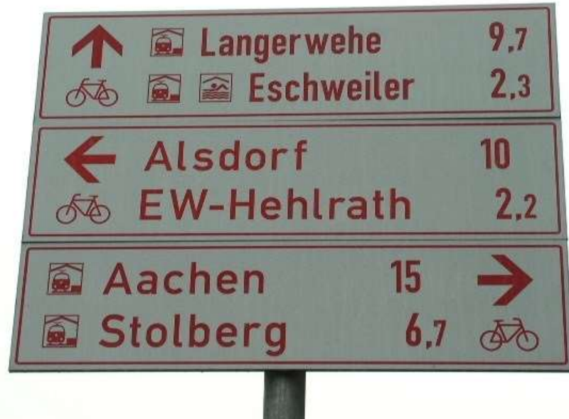
Abb. 3-7: Beispiel der Montagereihenfolge mehrerer Tabellenwegweiser nach Richtung (rechtsweisender Pfeil am rechten Rand des Wegweisers) (Quelle: SVK)
