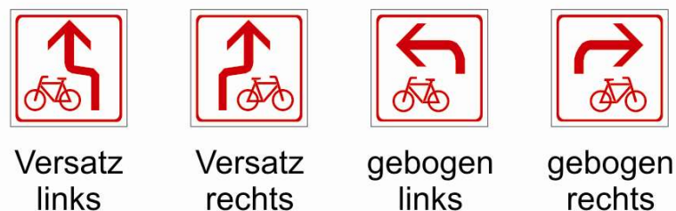
Abb. 3-19: Gestaltungsformen von Zwischenwegweisern bei Routenversätzen und vor dem Wechsel der Straßenseite (Standort vor der Einmündung)
