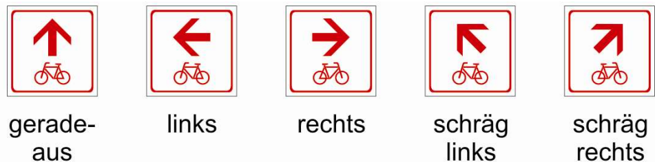
Abb. 3-18: Gestaltungsformen von Zwischenwegweisern zur Routenbestätigung (Standort hinter der Einmündung, vgl. Kap. 3.6.1)
