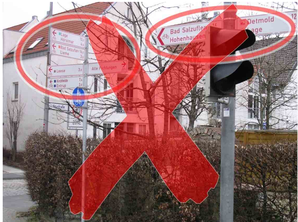
Abb. 8-4: Beispiel für eine unbedingt zu vermeidende Doppelbeschilderung (Mangel wurde zwischenzeitlich behoben)
